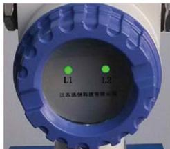
(2) 用磁铁触发（靠近）指示灯 L1，L1 变为红色常亮状态；L2 变为绿亮灭闪烁状态，持续约 10 秒后保持绿色静止。
