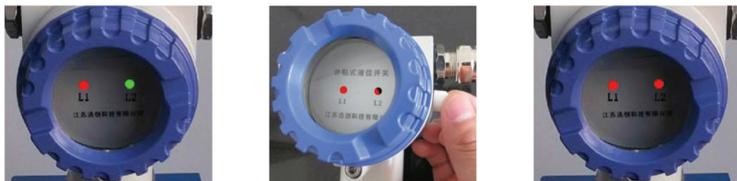
(4) 用磁铁触发指示灯 L1 为绿色常亮状态。即确认设置完毕，液位开关进入工作状态！
