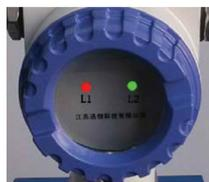
(3) 用磁铁再次触发指示灯 L1, L1 变为绿色常亮状态。即确认设置完毕, 液位开关进入工作状态, 若 L1 以绿色闪烁 30 下, 表示探头安装不恰当, 需重新安装探头。
