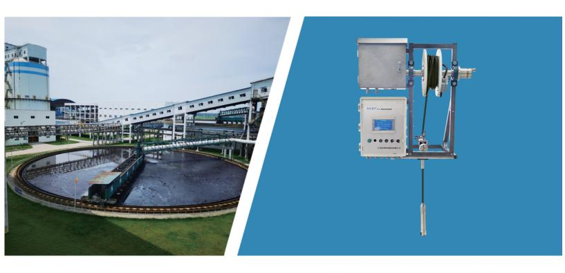
XC-CJ 煤泥水界面测量装置
